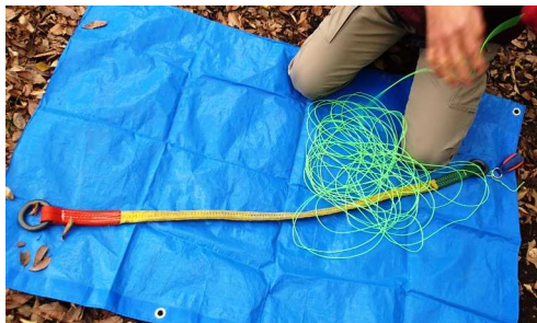
↑フリクションセーバー。左右に付いたリングの径が違い、スローウェイトが通る通らないがある。
